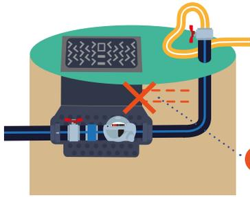
**⚠ Ne percez pas la réhausse du regard de compteur.** En polypropylène expansé, elle assure l'étanchéité et l'isolation thermique. Le raccordement au compteur se fait par le tuyau provisoire lors de la construction et en bas de la niche lors du raccordement définitif de vos installations sanitaires.
