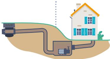
**Interdiction de raccorder les gouttières au réseau d'assainissement**
