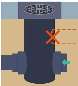
Ne percez pas le regard de branchement. Le raccordement se fait au niveau du tuyau prévu à cet effet.
