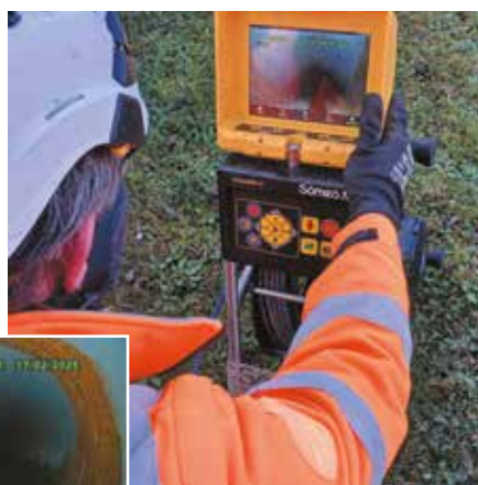
Images issues d'une inspection caméra montrant des défauts d'étanchéité sur les canalisations
